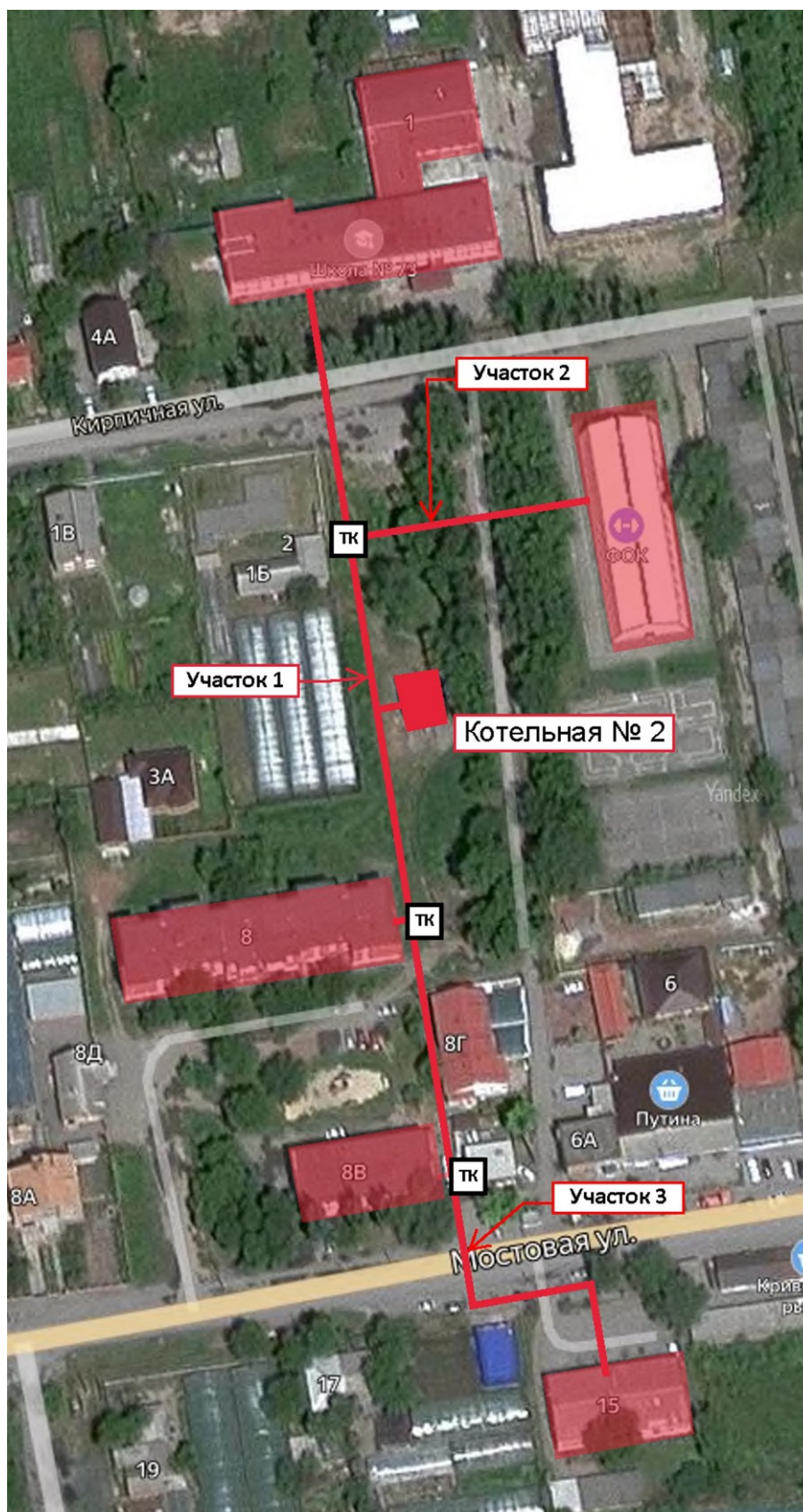
Рис. 2 – Схема тепловых сетей от котельной № 2 ст. Кривянской ул. Кирпичная д. 1Г
